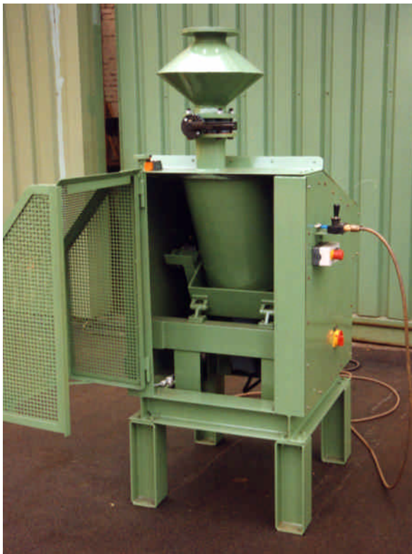
Abb.1: PKM Kernsandmischer in Entleerstellung mit einem Sandmengendosierbehälter
