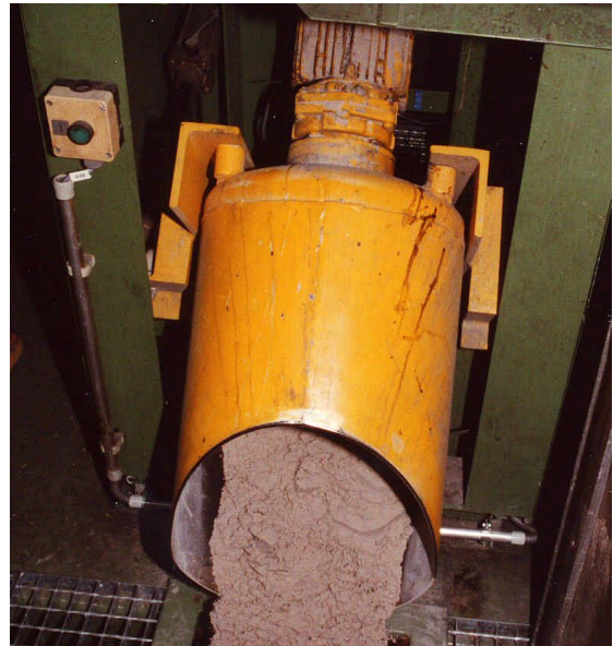
Abb. 2: PKM Mischer in ausgeklappter Entleerstellung
